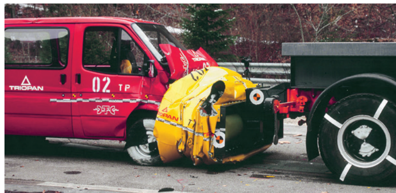
TMA und Knautschzone haben für eine effiziente und schonende Energieumwandlung gesorgt
