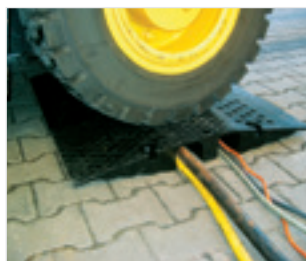
3) Obrócony mostek do węży spełnia rolę mostka kablowego
